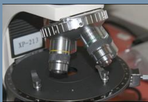
Mesa giratoria del microscopio para analizar minerales y rocas en secciones transparentes
